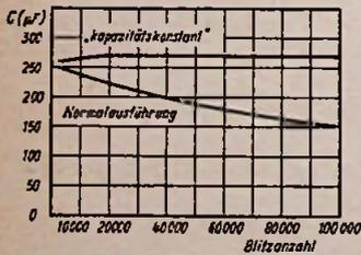
Güte entwickelten Ausführung ändert sich die Kapazität und damit die Lichtausbeute selbst nach 100 000 Entladungen nicht (Bild). Hersteller: K i k - G e r ä t e b a u GmbH, Köln-Deutz.
