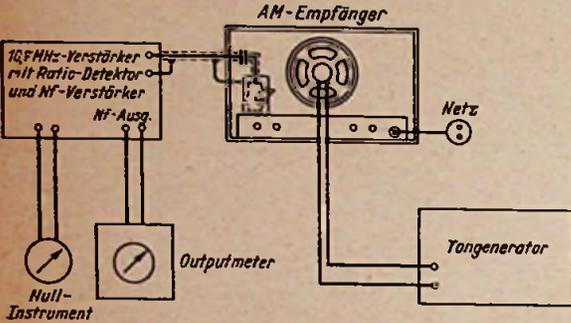
Bild 6. Prüfung eines AM-Empfängers durch Nachweis der Frequenzmodulation mittels eines FM-Zusatzgerätes
