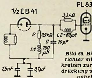
Bild 68. Bildgleichrichter mit Zusatzkreisen zur Zf-Unterdrückung und Höhenanhebung
