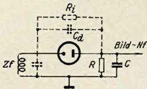
Damit der überwiegende Teil der Gesamtspannung an R zur Verfügung steht, sollten die äußeren Schaltelemente C und R eigentlich mindestens zehnmal größer als  $C_d$  und  $R_i$ , also  $35 \text{ pF}$  und  $5 \text{ k}\Omega$  groß sein. Andererseits darf aber C keinen Kurzschluß für die höchste Modulationsfrequenz von  $5 \text{ MHz}$  im Fernsehsignal bilden. Ein  $35\text{-pF}$ -Kondensator hat für  $5 \text{ MHz}$  bereits einen kapazitiven Widerstand von
