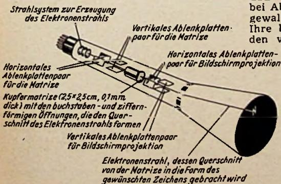
Aufbau des Charactrons, einer Oszillografenröhre mit vier Ablenkplattenpaaren zur Registrierung von Meßwerten
