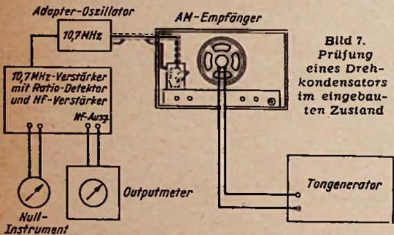
Bild 7. Prüfung eines Drehkondensators im eingebauten Zustand
