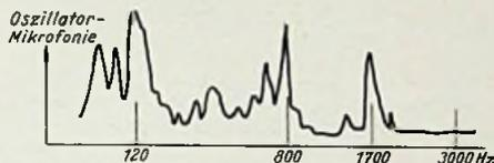
Bild 2. Mikrofonie eines Gerätes I im Antieferungszustand
