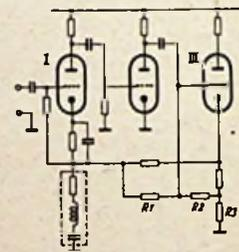
ting mit starker Gegenkopplung — werden Gittervorspannungen für verschiedene Röhren an gemeinsamen Widerständen (R 3) abgenom-men. Um z. B. den Einfluß des Anodenstromes der Röhre I auf die Gitter-spannung der Röhre III zu beseitigen, wird die Schaltung durch die Widerstände R 1 und R 2 zu einer Brücke ergänzt und die Gitterspannung der Röhre III an der Brük-kendiagonalen abgenommen.
