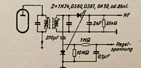
Bild 4. Kristalldioden als AM-Demodulator und Regelspannungs-Gleichrichter
