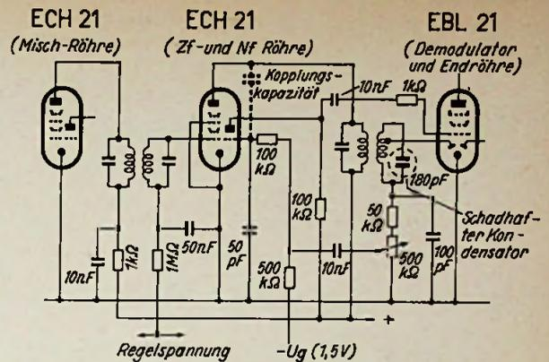
Durch Ausfall des letzten Zf-Kreises gelangte keine Spannung an die Gleichrichterdiode. Dafür wirkte, unter Umgehung des Lautstärkereglers, das Nf-Triodensystem als Demodulator
