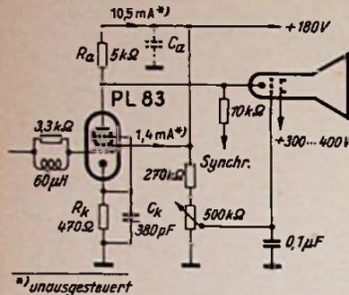
Bild 70. Bildendstufe mit Höhenanhebung durch Gegenkopplung am Katodenwiderstand
