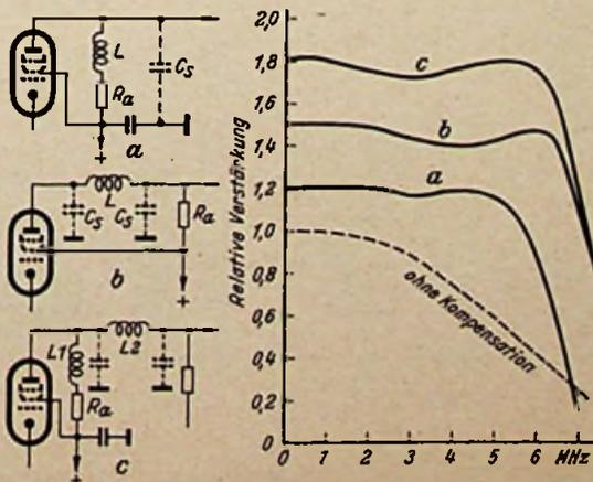
Bild 69. Verschiedene Arten der Höhenanhebung im Bild-Nf-Verstärker
