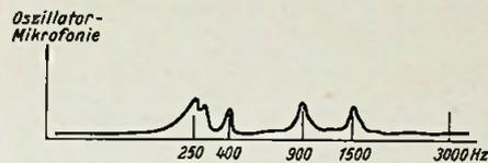
Bild 1. Mikrofonie eines nur durch Schallstrahlung angeregten Drehkondensators
