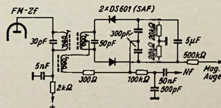
Bild 2. Verhältnis-Demodulator mit Kristalldioden im Loewe-Opta 2852 W
