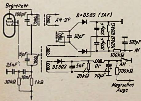
Bild 3. Kristalldioden als FM-Diskriminator und Ablenkspannungserzeuger für das Magische Auge (Lorenz „Zugspitze“)
