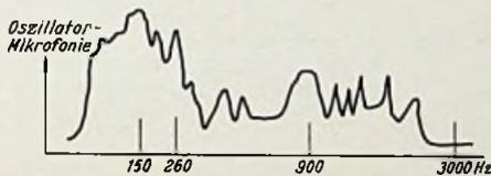
Bild 3. Mikrofonie eines Gerätes II im Antieferungszustand
