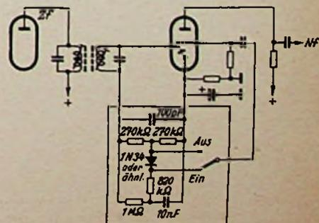
Bild 5. Einfache Störbegrenzungsschaltung für nachträglichen Einbau in Superhets
